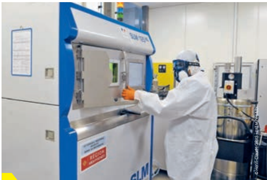
Machine de fabrication additive par fusion laser de poudre métallique ». La recherche dans les laboratoires de l'École des mines participe à l'innovation en Albigeois.
